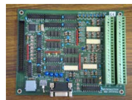
タイミング発生I/F基板 (1-MPU, 1-Up/Downカウンタ他)
