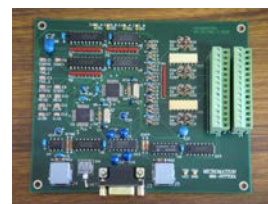
同期タイミング処理基板 (2-MPU, 2-Up/Downカウンタ他)
